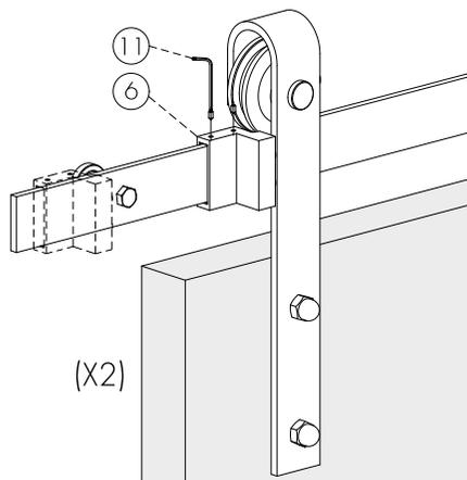
Определите крайние положения двери. Установите стопоры на направляющей относительно дверного проема и зафиксируйте их. Стопор может быть установлен как до первого крепления к стене, так и за ним. Для этого необходимо открутить крепежный винт и продвинуть стопор вдоль направляющей.
