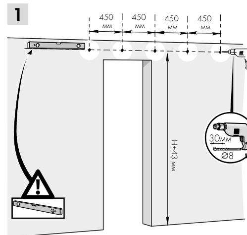
По уровню разметьте и просверлите отверстия в стене (Ø8 мм, глубина 30 мм) согласно схеме.
