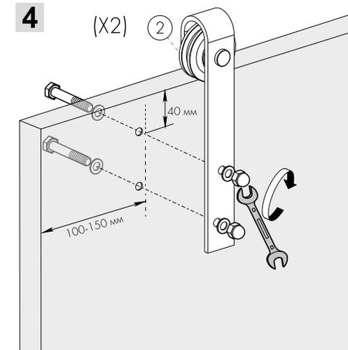
Закрепите ролики на дверном полотне.
