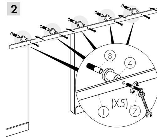
Вставьте резьбовые втулки с проставками. Закрепите верхнюю направляющую винтами M8.
